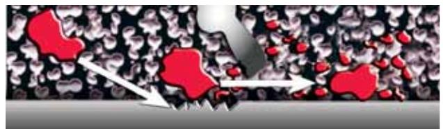
**METALLVENTIL:** Wenn abrasive Partikel auf Metall treffen, wird die Kollisionsenergie vom Metall absorbiert, was zu einem stetigen Verschleiß der Oberfläche führt.
