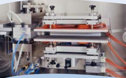
Heiz- und Formstation
