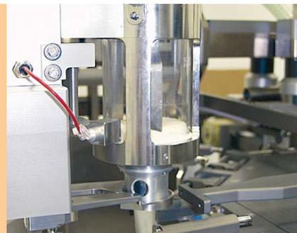
*Dosieren von Pulver über einen Schneckendosierer*
