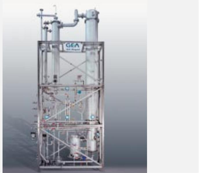
So lässt sich die zur Destillation eingesetzte Energie zur Aufkonzentrierung des feststoffhaltigen Sumpfpfproduktes aus der Kolonne weiterverwenden.
