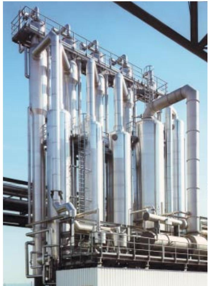
**Rechts:** 4-stufige, kontinuierlich arbeitende Rektifizieranlage mit nachgeschalteter Endstufe und Rückstandskonzentrierung für Prozesswässer aus der Herstellung von Hohlfasermodulen
