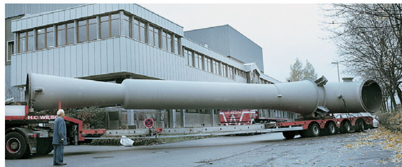
Strahlpumpe für eine 4-stufige Strahl-Vakuumpumpe zur Stahlgasung Saugstrom: 1.100 kg/h bzw. 1.387.000 m³/h, Saugdruck abs.: 0,6 mbar
