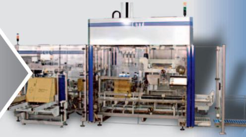
Kompaktpacker CP 888 mit Kartonaufrichtermodule.
