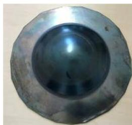
Zur Evaluierung von Materialeigenschaften bei erhöhter Temperatur ist ein spezielles Werkzeug erforderlich. Diese beheizbare Warmzieh-Vorrichtung ist geeignet um Prüfungen wie Nakajima- oder Marziniak-Tests zur Ermittlung der Grenzformänderungskurve FLC/FLD durchzuführen.
