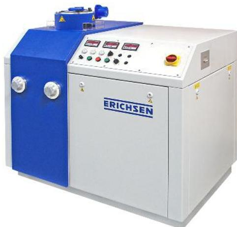
**Universal-Blechprüfmaschine mit automatischem Prüfungsablauf**
