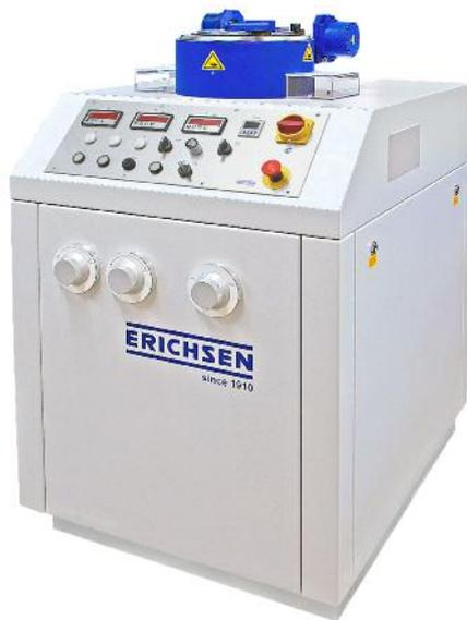
**Universal-Blechprüfmaschine mit automatischem Prüfungsablauf**
