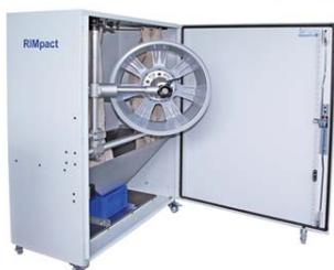
RIMpact II Felgenbeschusschrank zum Steinschlagprüfgerät MULTI GRIT TESTER 508 VDA. Zur normgerechten Steinschlagprüfung nach VDA an ganzen Felgen bis 26" (Einhaltung des vorgegebenen Beschusswinkels von 54° in Verbindung mit dem korrekten Beschussabstand).
