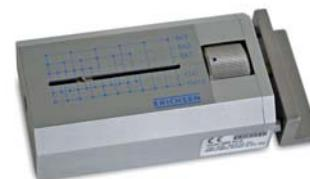
SCROLLRULER 295/XV: universelles Gitterschnittlineal, durch einfaches Drehen des Rändelrades einstellbar.
