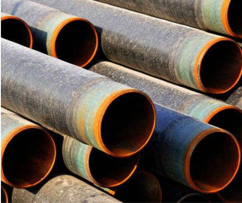
Die Rohrprüfung ist unser am engsten eingegrenztes Anwendungsfeld. Es bezieht sich auch auf die Norm für die Qualitätsüberprüfung von Rohrbeschichtungen DIN 30 670. Wir bieten Ihnen hierzu alle erforderlichen Prüflösungen: Die Messung des Eindruckwiderstands, der Mindestschichtdicke, Porenfreiheit, des Schälwiderstands, der Schlagbeständigkeit sowie der Wärmealterung.
