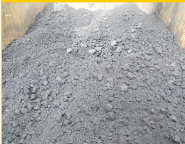
Trockener Kohle-Filterkuchen nach Dampf- Druckfiltration Restfeuchte: RF < 10 Gew%
