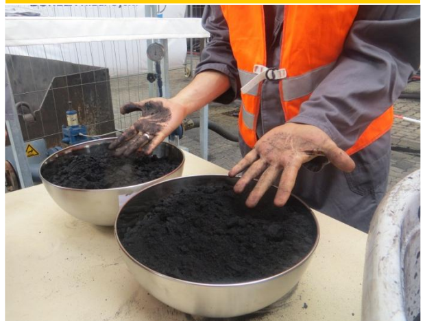
Sensorischer Test Handtest mit trockenem HiBar Filterkuchen (saubere Hand) und Bandfilterkuchen (schwarze Hand)
