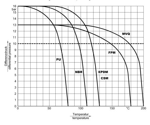
Ab DN 200 ist bei einem Differenzdruck über 13 bar der Einsatz von Sitzringen mit erhöhter Shore Härte erforderlich. Abflanscharmaturen: Im einseitig abgeflanschten Zustand max. Differenzdruck 6 bar. KG2 / KG4 und Armaturen ab DN 600: max. Differenzdruck 10 bar.
