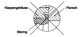
Die Spreizung der Rohrleitung aufheben und bei voll geöffneter Klappenscheibe die Flanschschrauben über Kreuz gleichmäßig und leicht anziehen.
