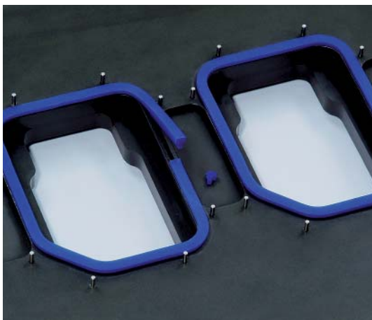
Siegelgummis und Federstifte der Siegelwerkzeuge lassen sich problemlos auswechseln
