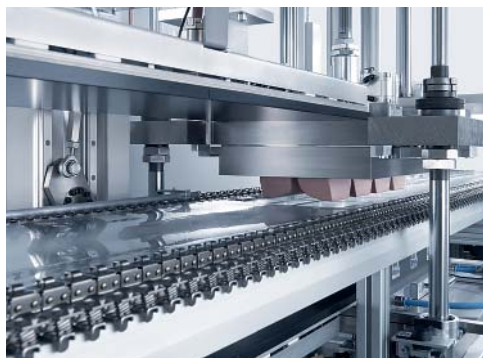
Blisterformstation der Blistermaschine KBS-KF
