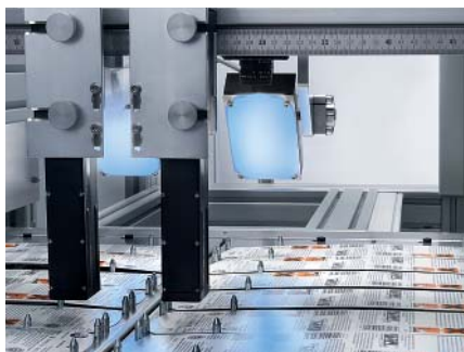
Beispielhaftes Druck- und Kamerasystem beim Drucken und anschließenden Prüfen variabler Produktdaten
