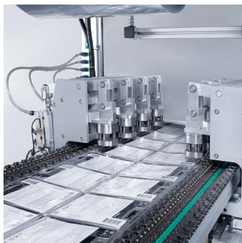
Kettentransport der Blistermaschine KBS-KF mit Stanze zur Euro-lochung des Blisters
