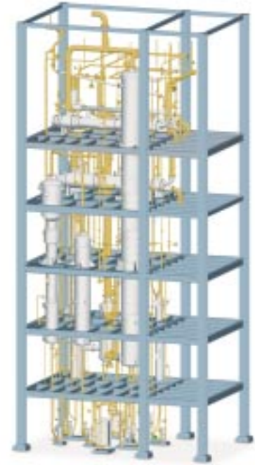
Fallstrom-/Gegenstrom-Riesel-Eindampfanlage mit Rektifikation zur Veredelung von Olivenöl
