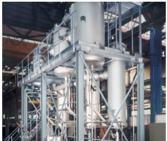
3-stufige Umlaufeindampfanlage für Glycerinwasser, Verdampfleistung: 3.600 kg/h
