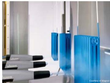
Überprüfen Sie in-Line in Echtzeit – Messung der Schichtdicke auf bewegten Teilen in der Beschichtungsanlage
